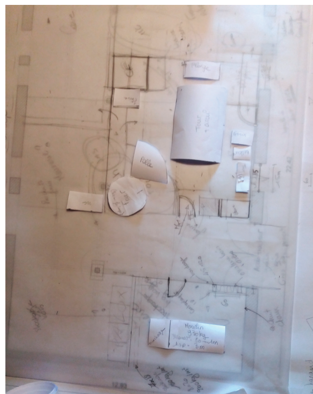
Photo 1 : travail à la main avec calques et papiers découpés figurant les équipements
