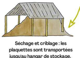
Séchage et criblage : les plaquettes sont transportées jusqu'au hangar de stockage.
